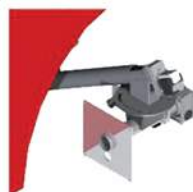
Doppia coclea con doppio motore combustibile, e movintazione rotante su 180° per la facile installazione in qualsiasi parte, inoltre questo sistema ha la facoltà di impedire i ritorni di fiamma ed i trafileamenti dei fumi di combustione verso il serbatoio di combustione Double auger with double fuel motor and 180° rotating handling for easy installation everywhere. Furthermore, this system prevents the flashbacks and the leakages of the combustion fumes towards the combustion tank.
