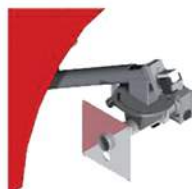
Doppia coclea con doppio motore combustibile, e movimentazione rotante su 180° per la facile installazione in qualsiasi parte, inoltre questo sistema ha la facoltà di impedire i ritorni di fiamma ed i trafileamenti dei fumi di combustione verso il serbatoio di combustione Double auger with double fuel motor and 180° rotating handling for easy installation everywhere. Furthermore, this system prevents the flashbacks and the leakages of the combustion fumes towards the combustion tank.
